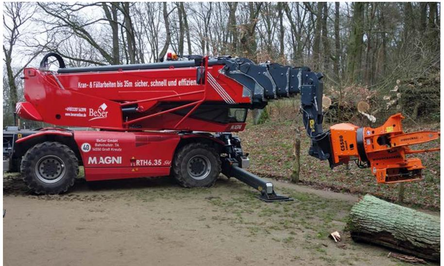
**Der Magni-Teleskoplader wird von einem Mercedes-Benz-Motor mit 231 PS angetrieben und sitzt sehr wartungsfreundlich und gut erreichbar an der rechten Seite der Maschine.**
