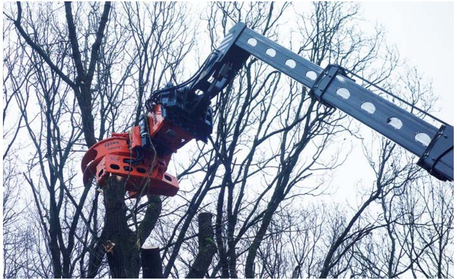
Mit dem Arbeitswerkzeug Woodcracker CS 580 Smart können auch dünnere Äste in der Baumkrone gezielt gegriffen, abgesägt und sicher gehalten werden.
