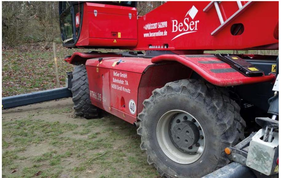
**Oben:** Durch die Hundeganglenkung ist die Maschine auch sehr geländetauglich.
