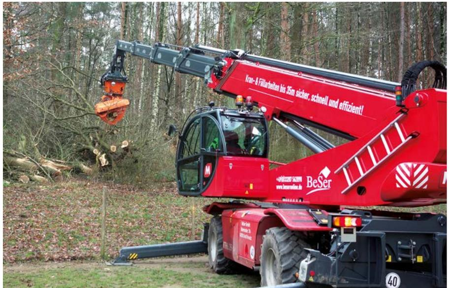
Die klimatisierte Kabine sieht sehr futuristisch aus. Über zwei Kameras hat der Fahrer den Fällkopf und den Raum hinter der Maschine immer im Blick.
